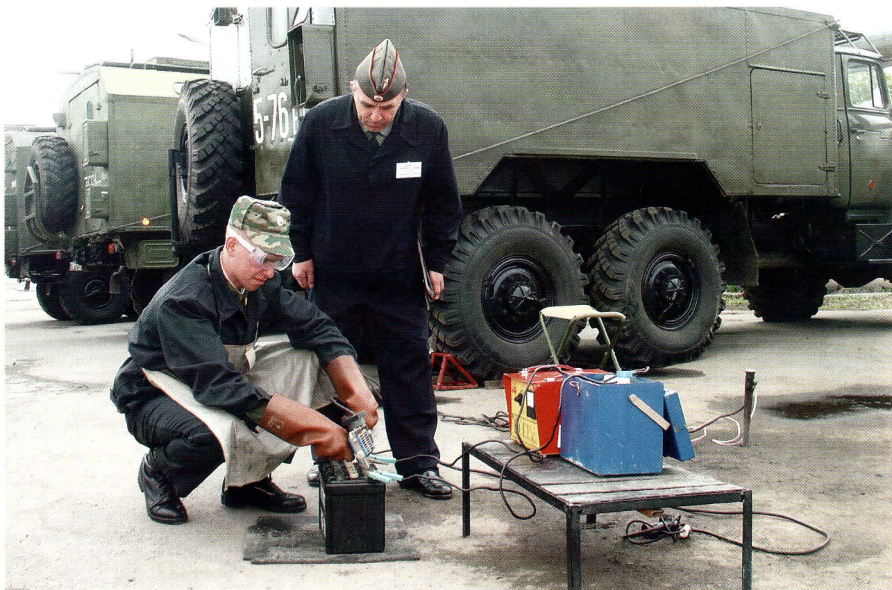
Проверка состояния аккумуляторной батареи
